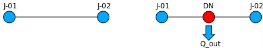
Abbildung 15: Schematische Darstellung der Methode, einen "virtuellen" Knoten an einer Leitung anzusetzen, um die Leakage der Leitung zuordnen zu können.
