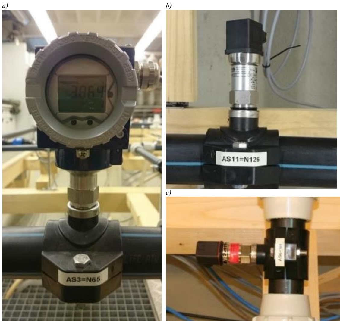
Abbildung 43: Drucksensoren unterschiedlicher Hersteller, Messbereichen und Genauigkeiten a) HART-fähiger Drucksensor 0-10 bar, 0.1% FS Genauigkeit, b) Drucksensor 0-6 bar, 4-20 mA Schnittstelle, 0.25% FS Genauigkeit. c) Drucksensor 0-6 bar, 0.5% FS Genauigkeit
