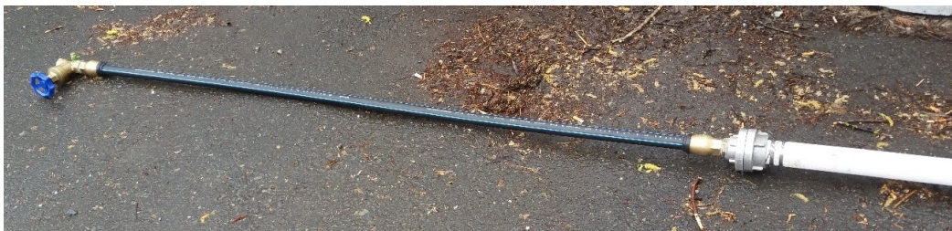
Abbildung 63: Rohrabschnitt zur Simulation von Leckagen unterschiedlicher Größe im Feld
