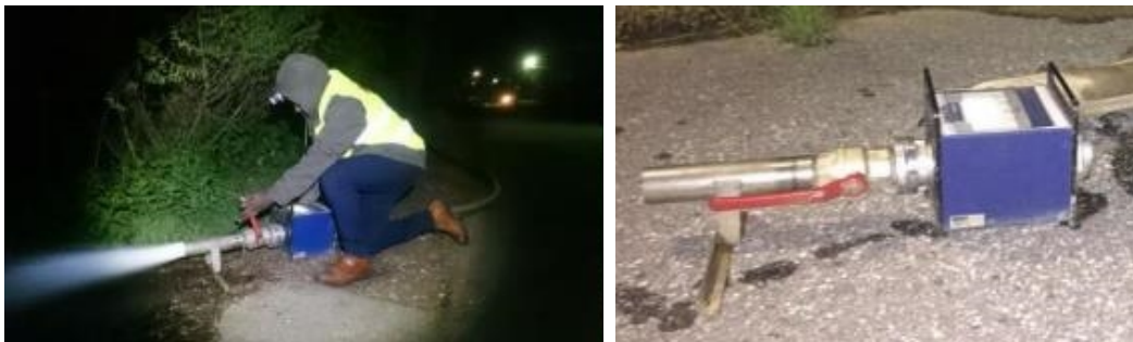
Abbildung 62: Kalibrierungsmessung mit Hydranten-Prüfgerät
