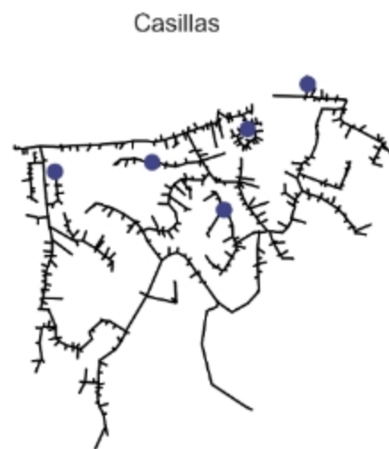
Abbildung 120: Ideale Sensorpositionen berechnet mit projektionsbasiertem Ansatz von Casillas
