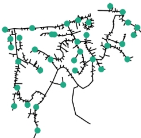
Abbildung 112: Mögliche Sensorpositionen an Hydranten im Modell Hart bei Graz
