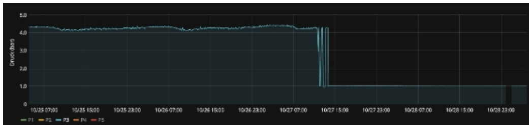
Abbildung 103: Druckmessung an einem Hydranten, der unabsichtlich geschlossen wurde
