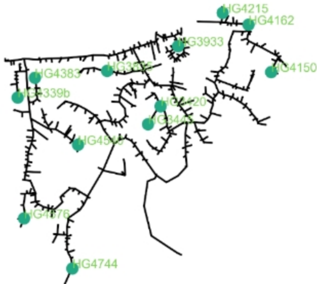
Abbildung 113: Positionen aller Sensoren im Netz Hart bei Graz beschriftet mit Knotennamen aus dem EPANET-Modell
