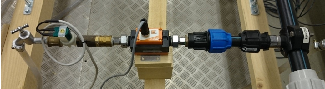
Abbildung 44: Vorrichtung zur Simulation von Verbraucher oder Leckage
