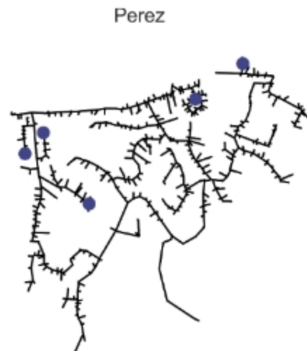
Abbildung 119: Ideale Sensorpositionen berechnet mit dem Algorithmus nach Pérez mittels Binärisierung der Sensitivitätsmatrix
