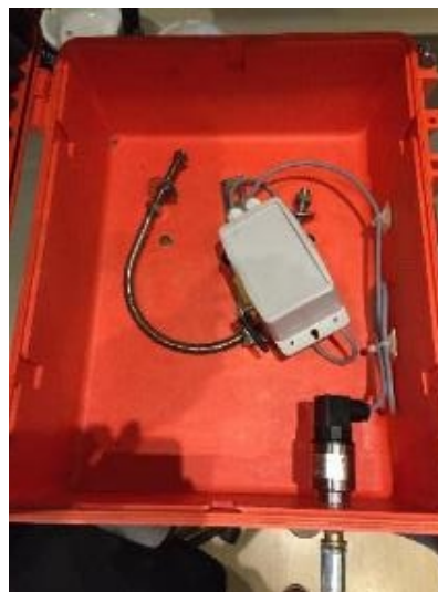
Abbildung 106: Inhalt eines Messkoffers, wie sie an den Hydranten und an den Hausanschlüssen installiert wurden. In der Mitte ist das Datenübertragungsmodul zu sehen, unten der Drucksensor. Bei den Hydrantenmessungen befindet sich zusätzlich eine Batterie im Messkoffer.
