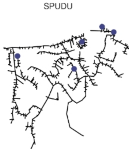
Abbildung 121: Ideale Sensorpositionen unter Einbeziehung von Verbraucherunsicherheiten mittels des SPuDU-Algorithmus
