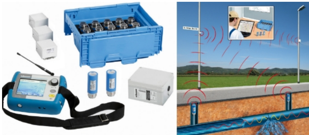
Abbildung 9: Geräuschlogger und Funktionsprinzip (Quelle: www.sebakmt.com )
