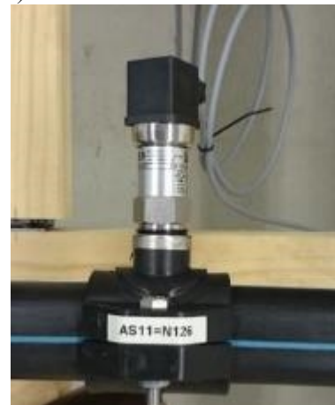
Abbildung 35: a) System Klemmfitting ,b) Anbohrschelle vor Einbau und c) inkl. eingebautem Drucksensor (Quelle: www.plasson.de )
