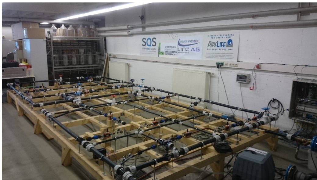
Abbildung 30: Vollausbau des experimentellen Trinkwasserverteilnetzes im Technikum des Instituts für Siedlungswasserwirtschaft und Landschaftswasserbau der TU Graz
